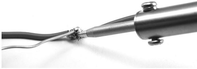
FIGURE B-4: RUNNING SOLDER INTO THE JOINED WIRES
