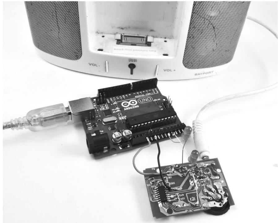
FIGURE 10-5: FM RADIO FREQUENCY HOPPER
