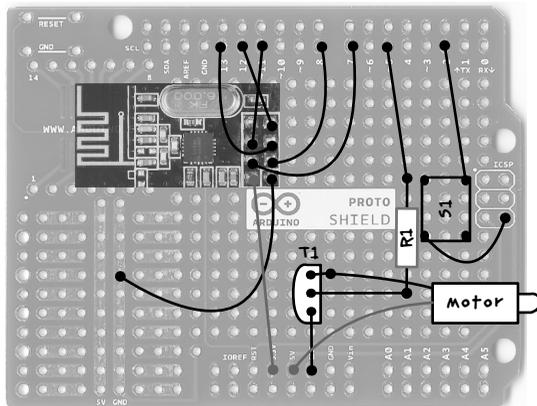
**FIGURE 11-5: THE PROTOSHIELD LAYOUT, WHERE R1 IS THE RESISTOR, S1 IS THE SWITCH, T1 IS THE TRANSISTOR, AND THE DARK RECTANGLE AT THE TOP LEFT IS THE NRF24**
