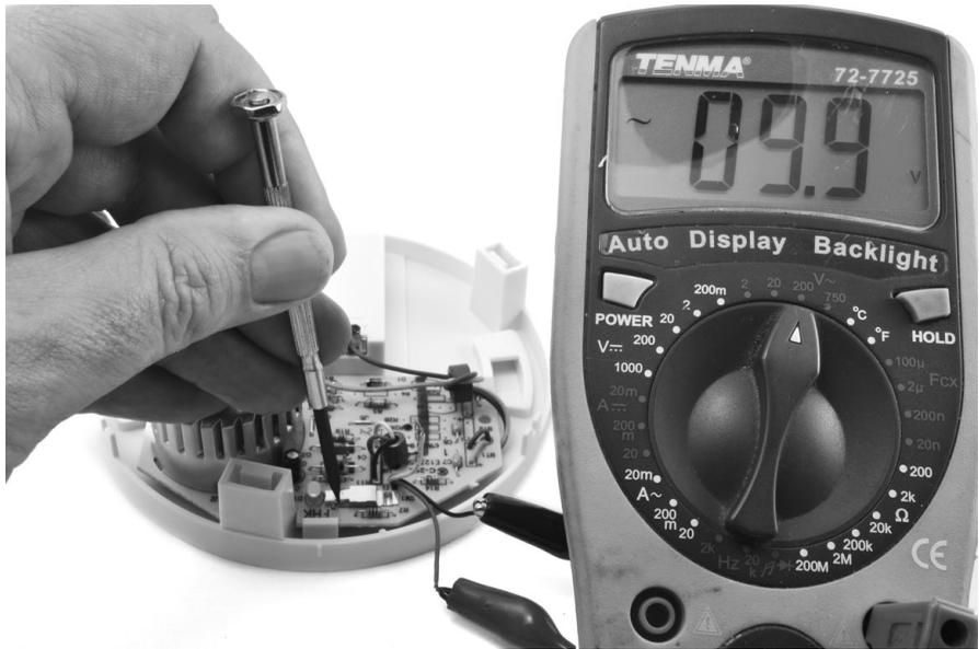
**FIGURE 7-6: IDENTIFYING THE SMOKE ALARM BUZZER WIRES**
